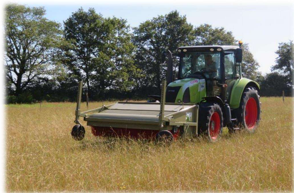
Figure 33 : La brosseuse à graines réalisée par le CEN (Crédit : CEN Nouvelle-Aquitaine)
